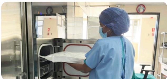
Equipos de Peróxido de Hidrógeno y Autoclave con autogenerador de vapor, con cámara de 700 litros, que permite realizar procesos de esterilización de 8 cajas de 11 kilos en un ciclo de esterilización, que garantiza la disponibilidad de material estéril para realizar intervenciones quirúrgicas.
